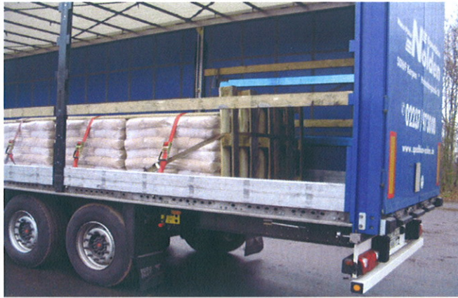
Foto 2: Diagonalverzurrung / Kopflaschung hinten
