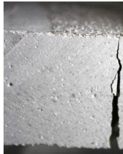
Bei den Proben aus dem Bereich der Rissanierungsarten A und B erfolgte der Bruch immer neben dem sanierten Riss.
