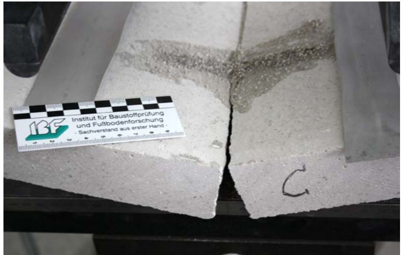
Neben den erzielten Biegezugfestigkeiten sind die Bruchbilder entscheidend.
