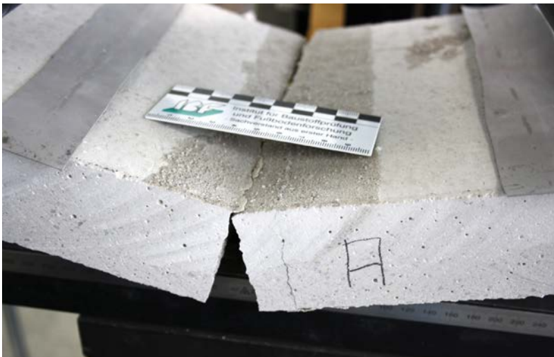
Bei den Proben aus dem Bereich der Rissanierungsarten A und B erfolgte der Bruch immer neben dem sanierten Riss.
