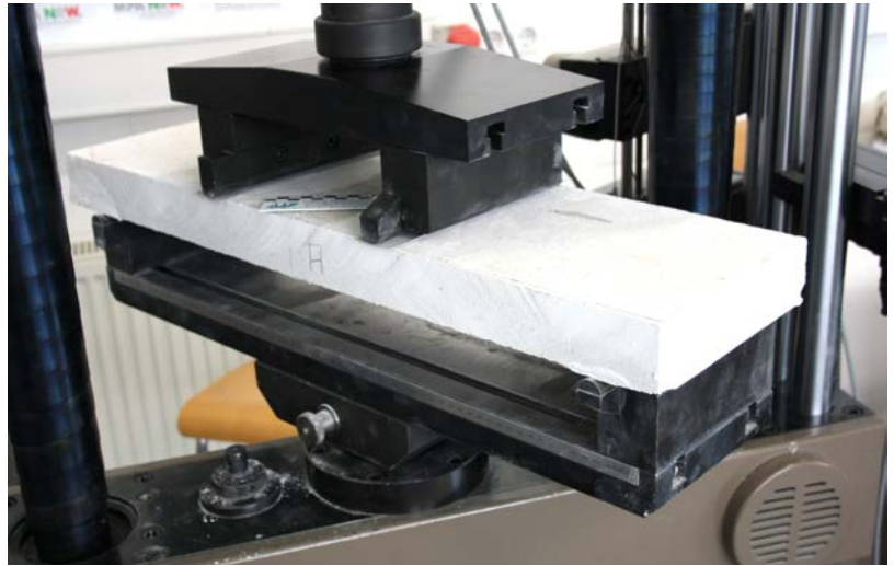
Neben den erzielten Biegezugfestigkeiten sind die Bruchbilder entscheidend.
