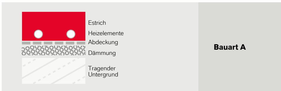
Bei Heizestrichen der Bauart A ist die jeweilige Nenndicke um den Durchmesser der Heizrohre zu erhöhen
